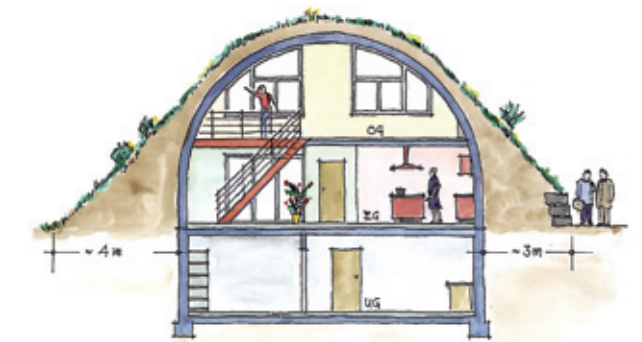
Schnitt durch das Erdhügelhaus (Schema Archy Nova).
